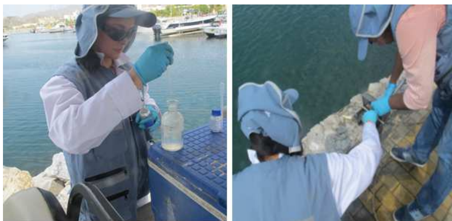
Figura 3. Toma de muestras de agua y sedimentos, y medición de parámetros fisicoquímicos “in situ” en los puntos de muestreo de la Marina Internacional de Santa Marta el 04 de septiembre de 2015.
