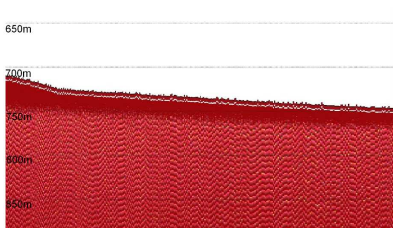
Figura 16. Perfil sísmico correspondiente a la estación EA 339 que muestra el aspecto del fondo registrado con el cristal de 38 kHz. El fondo marino es regular y suavemente inclinado con una pendiente que varía entre 3,9^\circ y 2,3^\circ . Las irregularidades batimétricas en el fondo son errores en la adquisición.
