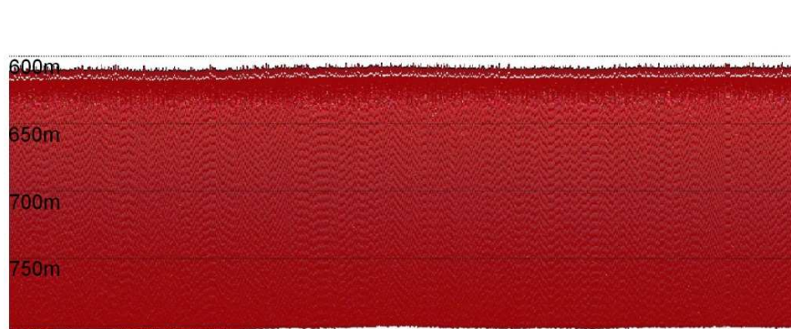
Figura 13. Perfil sísmico correspondiente a la estación EA 336 que muestra el aspecto del fondo registrado con el cristal de 38 kHz. El fondo marino es plano y horizontal con algunos picos batimétricos que corresponden a errores de adquisición.
