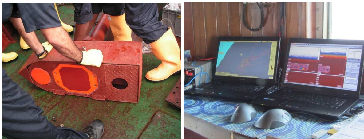
Figura 2. Transductor de 38 kHz empleado para el reconocimiento de los fondos submarinos de la zona de estudio (izquierda). Visualización de los perfiles batimétricos en los computadores de la ecosonda ubicados en el puente de la embarcación (derecha).
