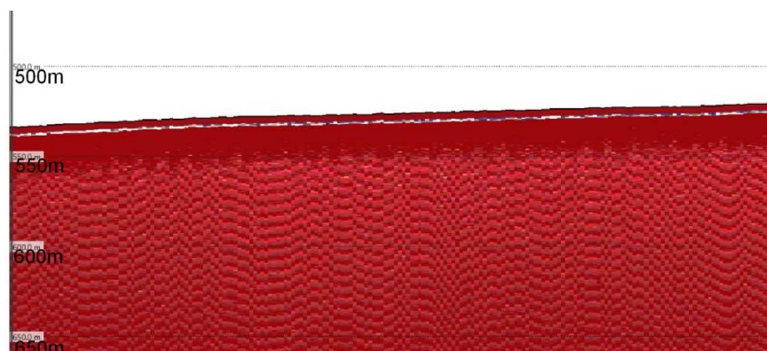
Figura 14. Perfil sísmico correspondiente a la estación EA 337 que muestra el aspecto del fondo registrado con el cristal de 38 kHz. El fondo marino es muy regular y suavemente inclinado.
